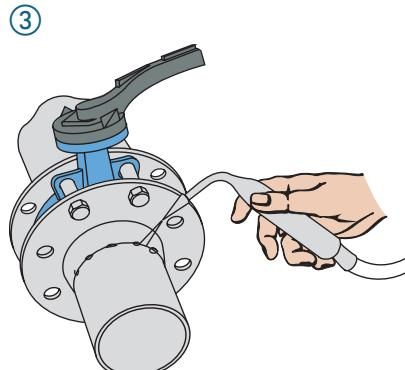
Die Rohrleitungsflansche mit elektr. Punktenschweißung an die Rohrleitung anheften.
