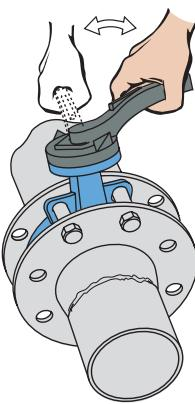
Klappenscheibe öffnen und prüfen, ob diese frei beweglich ist. Klappenscheibe leicht geöffnet lassen.
