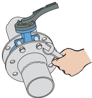
Absperrklappe ausrichten und 4 Flanschschrauben leicht anziehen.
