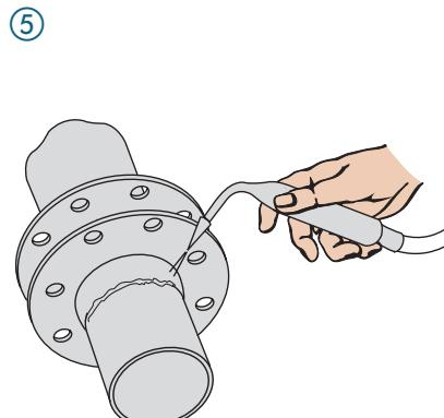
Flansche an die Rohrleitung anschweißen.
